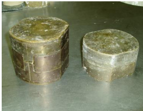
Рис. 2. Зуботехнические кюветы: а – с дополнительным кольцом, в – стандартная
