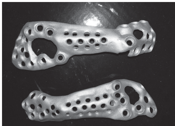
Рис. 4. Отлитые из титана эндопротезы
